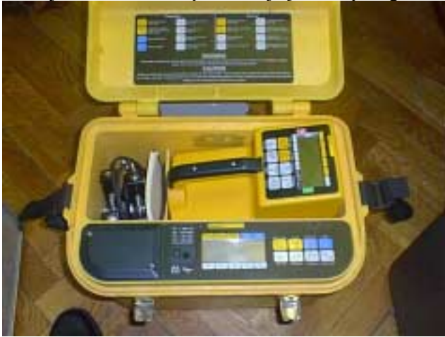
Slika 11.17. Tragač kabela u prikladnom kovčegu
