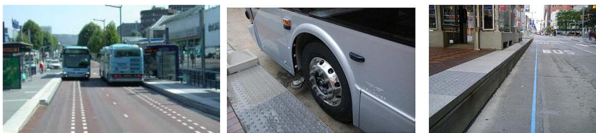
Slika 7.14. Automatsko vođenje i zaustavljanje vozila
